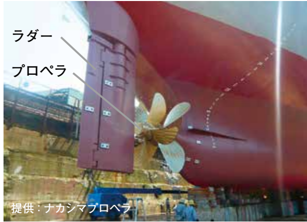
ラダー プロペラ 提供：ナカシマプロペラ 下の方に人が写っています。船はもちろん、機器1つひとつがとても大きいことがわかります。
